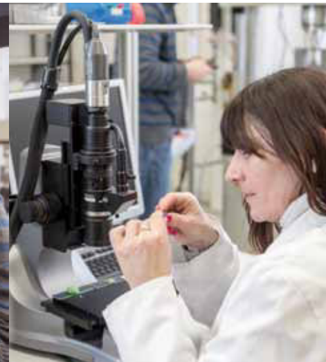
Dr. Claudia Bucharsky bei der fraktographischen Nachuntersuchung an den Bruch- flächen der getes- teten Proben
