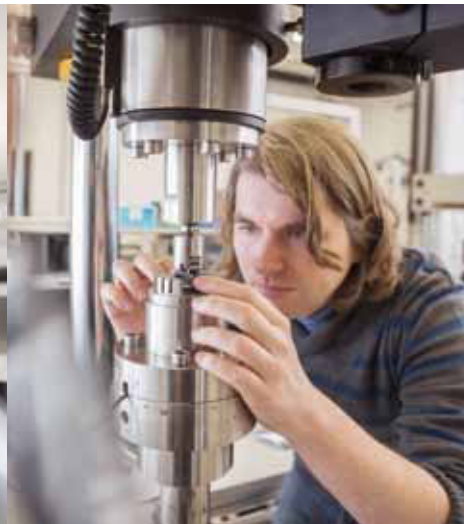
Dr. Günter Schell beim Einbau einer Probe zur Festig- keitsbestimmung
